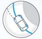
**MIT DER INTELLIGENTEN SPURKONTROLLE** behalten Sie jederzeit die Kontrolle. Das System bremst in Kurven die kurveninneren Räder leicht ab und sorgt so für ein agileres und sichereres Fahrverhalten.
