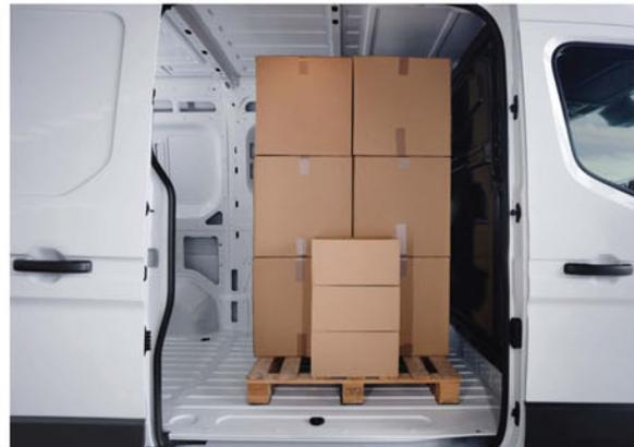
Robuste und flache Trennwand & Schiebetür mit 1.310 mm Durchlassbreite
