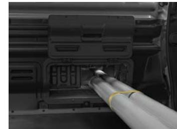
Die Klappe in der Trennwand ermöglicht den Transport von extralangen Gegenständen – bis zu 3,75 m in der L1- und bis zu 4,15 m in der L2-Version.\*
