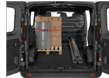
Die seitlich angeschlagenen Hecktüren öffnen sich für einen ungehinderten, 1,30 m breiten Zugang bis zu 180° (270° optional).\*\*
