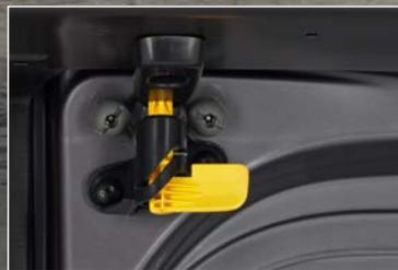
Dieses praktische Scharnier ermöglicht Ihnen, eine Hecktür offen zu arretieren und längere Ladung sicher zu transportieren.
