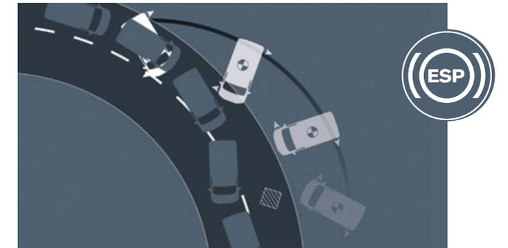
Weiter überwacht die Fahrdynamikregelung (ESP) beständig Ihr Lenk- und Bremsverhalten, identifiziert Über- und Untersteuerung und hilft, dies durch eine Reduzierung der Geschwindigkeit und das Abbremsen einzelner Räder auszugleichen.
