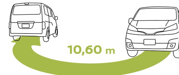
Der NISSAN EVALIA hat einen beeindruckend engen Wendekreis von 10,60 m (von Bordsteinkante zu Bordsteinkante). In Verbindung mit seiner Gesamtlänge von nur 4,40 m lässt er sich so einfach und sicher durch dichten Verkehr und in enge Parklücken manövrieren.
