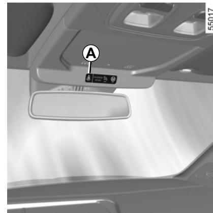
Je nach Fahrzeug: wenn der Sitz belegt ist und einer dieser Sicherheitsgurte nicht angelegt ist oder abgelegt wird, während sich das Fahrzeug mit einer Geschwindigkeit von mehr als etwa 20 km/h bewegt, blinkt
