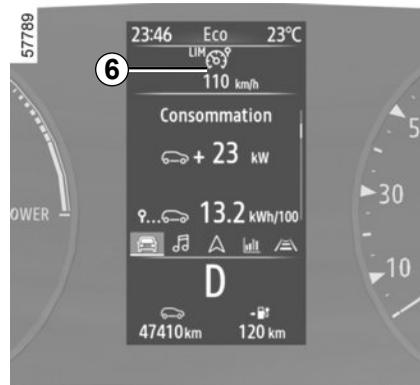
Um die aktuelle Geschwindigkeit zu speichern, drücken Sie die Taste **4 (RES/+)** oder **3 (SET/-)**: Die Grenzgeschwindigkeit ersetzt die Bindestriche und die Kontrolllampe **6** wird je nach Fahrzeug in Weiß angezeigt.
