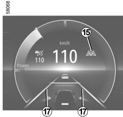
Wenn der Fahrer nicht eingreift, vibriert das Lenkrad um anzuzeigen, dass das Fahrzeug in Kürze die Fahrspur verlässt und der Fahrer unverzüglich die Kontrolle übernehmen muss.
