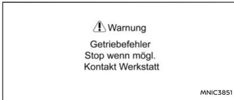
Wenn die Ausfallsicherung aktiviert wird, wird die Fahrgeschwindigkeit automatisch verringert, um das Risiko von Schäden am Hybridgetriebe zu reduzieren. Die Fahrgeschwindigkeit kann mit dem Gaspedal gesteuert werden, die Motorleistung kann jedoch eingeschränkt sein. Die Warnmeldung [Getriebefehler] erscheint auf der Fahrzeuginformationsanzeige. Lassen Sie das Hybridgetriebe bei einem NISSAN-Händler oder einer qualifizierten Werkstatt prüfen und reparieren.
