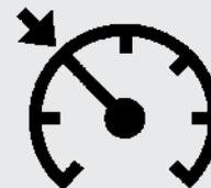
**Wenn das System nicht einwandfrei funktioniert, wird ein akustisches Hinweissignal ausgegeben und die Farbe der Anzeige des Tempomaten wechselt zu Gelb.**
