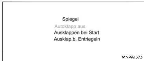
Die Außenspiegel werden automatisch ausgeklappt, wenn die Zündung eingeschaltet wird oder wenn die Fahrzeurtüren entriegelt werden. Verwenden Sie das Menü [Spiegel] der Fahrzeuginformationsanzeige, um den Moment zu wählen, in dem die Spiegel automatisch ein- und ausgeklappt werden sollen. Die automatische Ein-/Ausklappfunktion kann auch ausgeschaltet werden. Siehe "[Fzg.Einstellungen]" (S.89).
